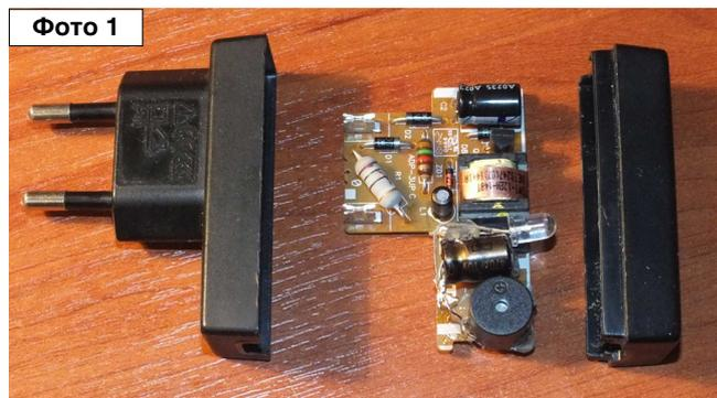
Так что, если не нужна большая громкость, можно использовать излучатель на 12 В при питании от 5 В. Я использовал излучатель типа HCM1212X.
