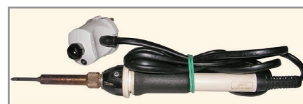
Рис. 4. Японский паяльник с керамическим нагревателем мощностью 15 Вт (лампа NE-2В – 3,8 × 10 мм, R3-СП4-1 – 33 кОм)
