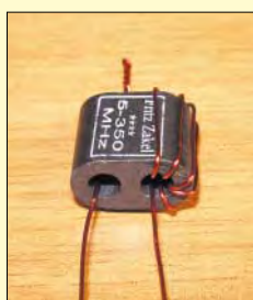
Bild 10: Insgesamt sind fünf Windungen aufzubringen.
